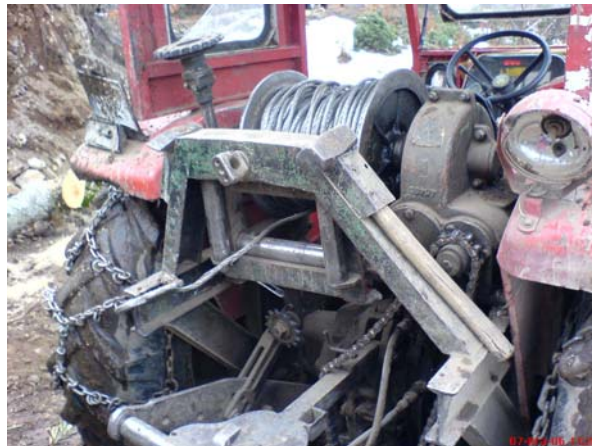
Şekil 1. Traktörün arka kısmına eklenen tambur (Foto: E.İlhan)
