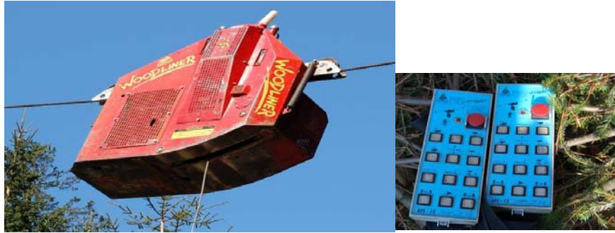
Şekil 3. Woodliner Vagon ve Uzaktan Kumanda Aparatı
