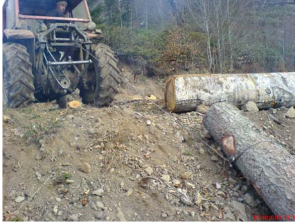
Şekil 2. Yol üzerinde sabit duran traktör ile tomrukların çekilmesi (Foto: E.İlhan)
