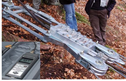
Şekil 4. SEIK kablo Gerilim Ölçme Aleti
