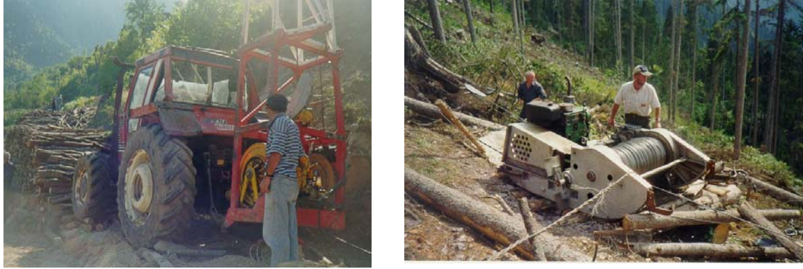
řekil 3. a) Koller K300 hava hattı b) Gantner hava hattı (Foto: T.Öztürk)
