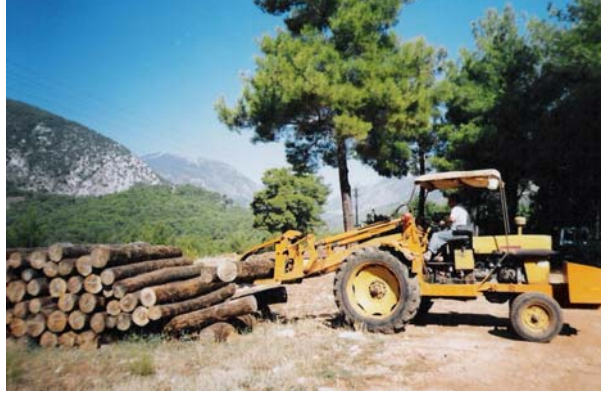
Şekil 4. Yükleyici olarak kullanılan tarım traktörü (Foto: T.Öztürk)
