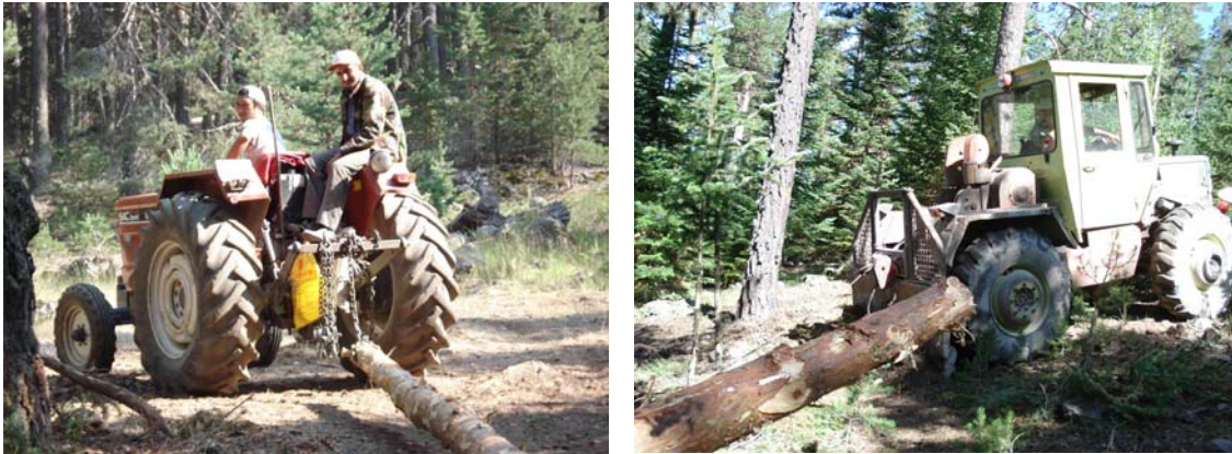
Şekil 2. a) Tarım traktörü ile sürütme b) MB Trac 900 ile sürütme (Foto: K.Cantürk)
