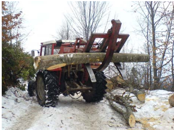
Şekil 3. İstifleyici olarak kullanılan tarım traktörü (Foto: E.İlhan)
