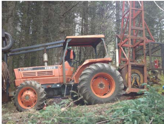
Şekil 6. Traktöre monte edilen Koller K300 vinçli hava hattı (Foto: T.Öztürk)
