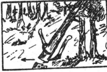
ŞEKİL - 27 Devrilmesi sırasında çevredeki herhangi bir yere dayanan ağacın sapın ve çevirme çeneliyle düşürülmesi.
